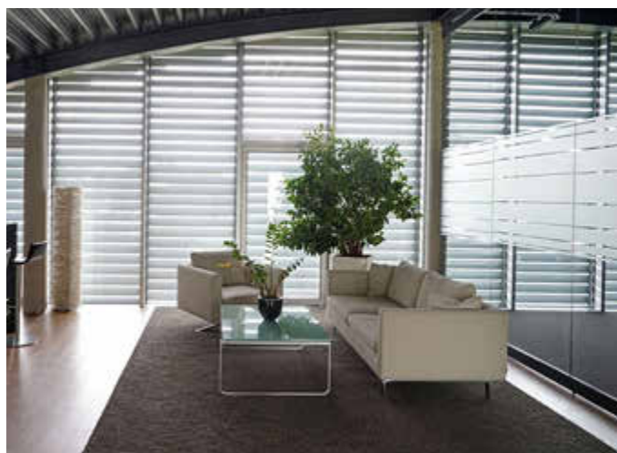
Durch die Lichtschienen, mit denen sich einzelne Lamellen der Rollläden ersetzen lassen, fällt Tageslicht wie bei einem Laubschatten unter Bäumen ein. Foto: djd/Schanz Rollladensysteme
